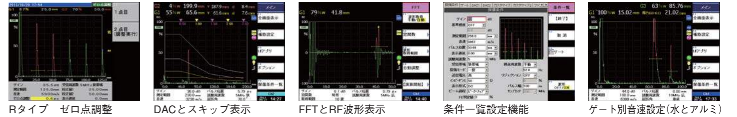
Rタイプ ゼロ点調整 DACとスキップ表示 FFTとRF波形表示 条件一覧設定機能 ゲート別音速設定(水とアルミ) *主な標準機能:AWS D1.1機能、曲率補正機能、JIS・AWS・ASME-DAC作成機能、4ゲート、音速測定機能、Bモード(タイムスクロール)、JSNDI機能、サスペンド機能、ゲート別AGC機能・音速設定、DAC線(12本)間隔任意設定、スキップ表示など便利な機能が満載。
