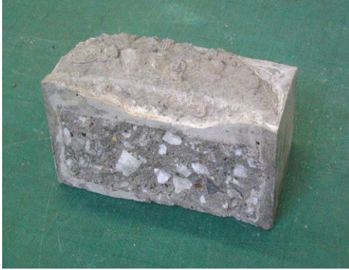
写真14 コンクリート充填不足の供試体
