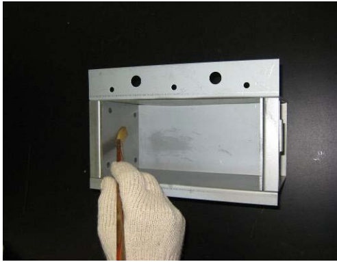
写真7 端面板内側の剥離剤の塗布
