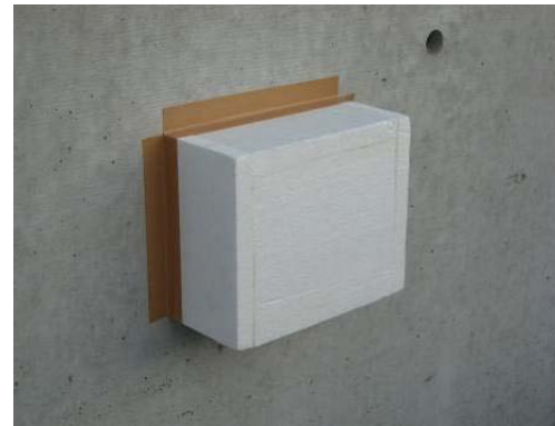
写真17 断熱材による養生（例）
