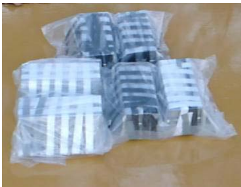
写真 22 ボス供試体の封かん養生
