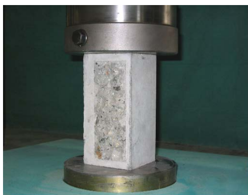
写真23 圧縮強度試験の状況
