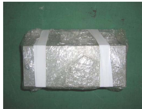
写真 22 ボス供試体の封かん養生
