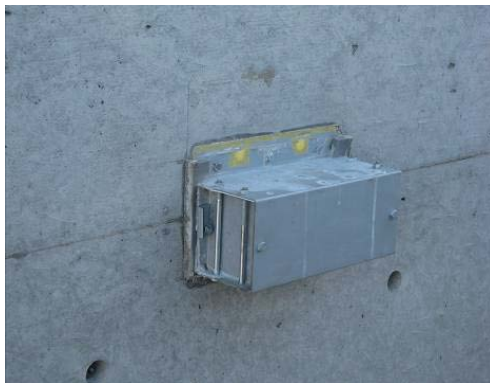
写真16 ボス供試体の養生
